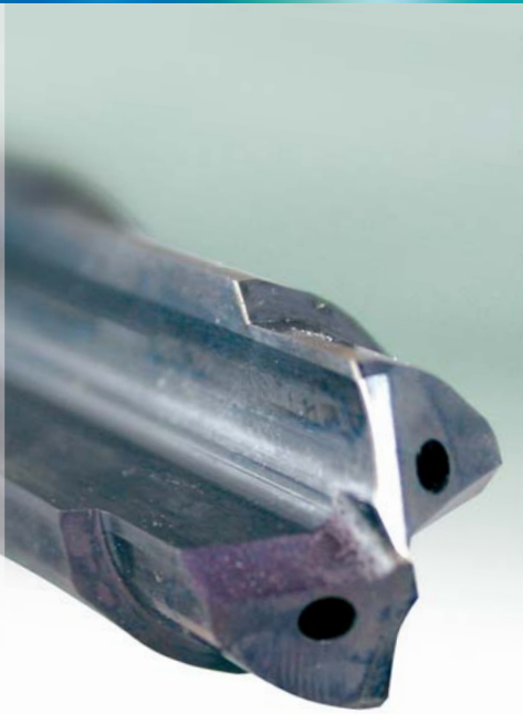
Abbildung: Durchgehende Hohlnut verbessert die Spanformung bei einfacher Nachschleifbarkeit.
