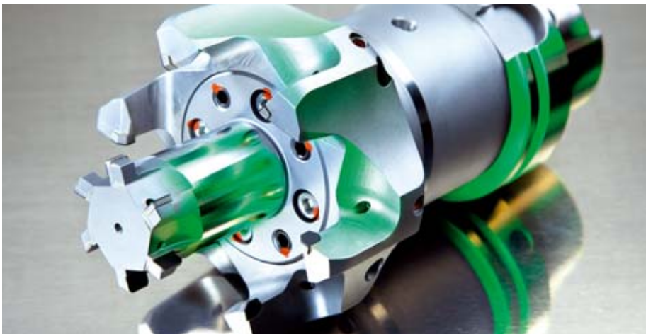
Innen- und Außenzirkularbearbeitung eines Lenkrohres werden in ein einziges Werkzeug integriert.
