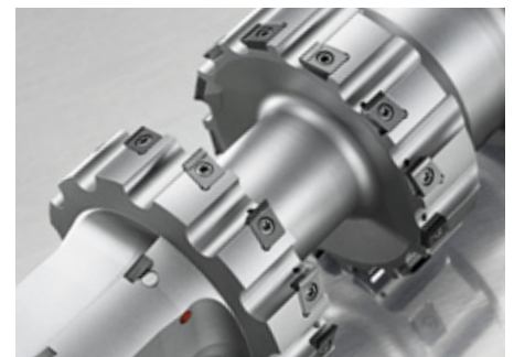
Schritt 3: Satzfräser mit PKD-Wendepplatten (ein- stellbar)
