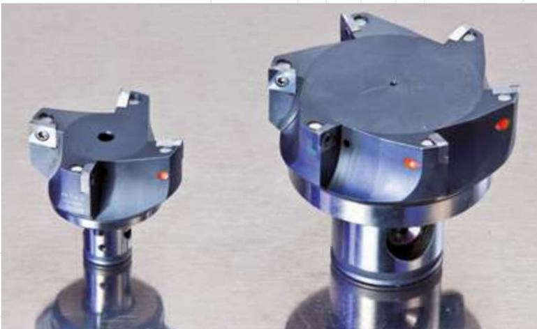
Um die Gratbildung beim Überfräsen von Flanschflächen auf ein absolutes Minimum zu reduzieren, kann der Anwender zwischen mehreren Schneidplatten mit positiven Spanwinkeln auswählen. Neben der Gratbildung wird dabei die Schwingungsneigung des Bauteils und damit die erreichbaren Vorschubgeschwindigkeiten positiv beeinflusst.
