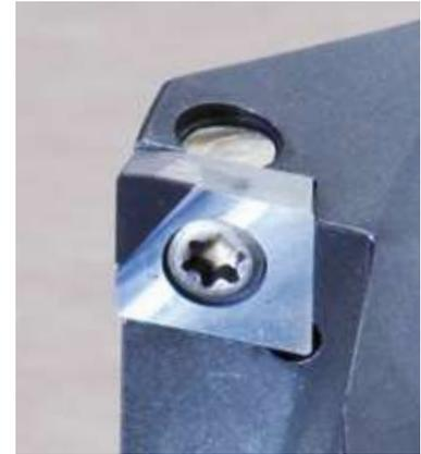
unter optimalen Bedingungen in die großen Spanräume ab. Die eingesetzte PKD-Fräsplatte kann für alle Durchmesser des HSC-Flex-Cutter-Programms verwendet werden.
